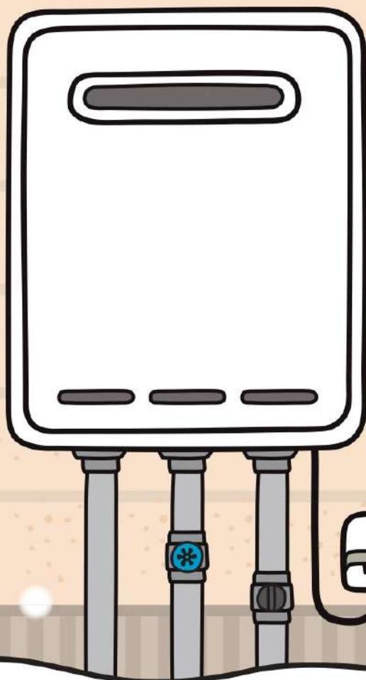
ガス給湯器には、凍結予防ヒーターが装備され、自動で機器内部の凍結予防を行うことのできる機種もあります。この時期、特に気温の下がる夜間や早朝時には、ガス給湯器や配管内の水が凍結して、お湯が出なくなる場合があります。
